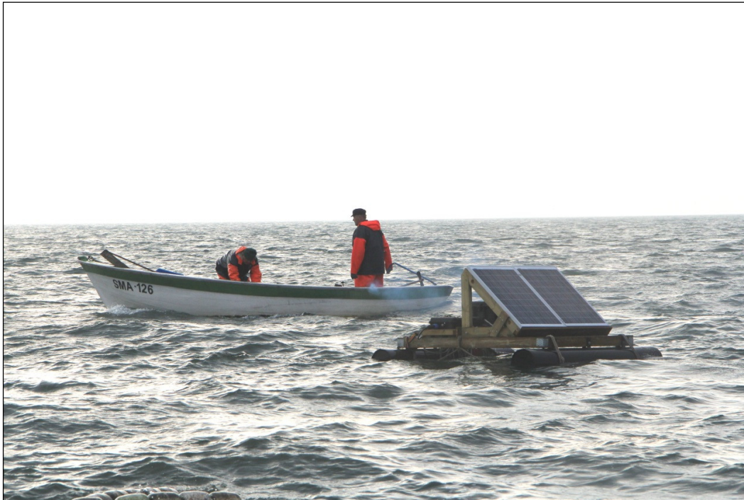
Joonis 12. Hülgepeleti katsetamine Saaremaal räime- ja tuulehaugipüügil (Foto: Markus Vetemaa).
